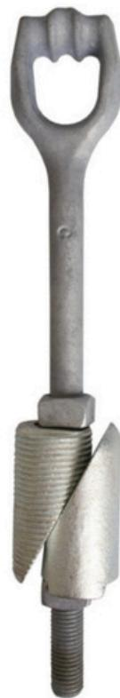
**Sustav Halas /Expanding rock anchor je prvi razvio i testirao u ranim 1980-ih John Halas, Key Largo sastoji se od pina/navojne šiške izrađenog od nehrđajućeg ili pocinčanog čelika koji se umeću u bušotine definiranih dubinaBušenje se vrši namjenskim hidrauličnim alatom u morskom dnu klase 1. Postavljeni pin u bušotini se mogu naknadno ispunitisa punilom (epoksi ljepilom ilibrzoveznim cementom) radi dodatne sigurnosti.**
